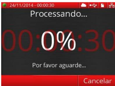
Para realizar o update de firmware primeiro insira um “Pendrive”, contendo o firmware do equipamento, na porta USB não fiscal. Em seguida pressione o botão UPDATE na tela “Sobre”. O processo de update de firmware será iniciado. Aguarde até que o processo seja completado.
