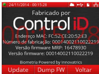
Para acessar a opção de dump de firmware, pressione DUMP FW na tela “Sobre”. O firmware será então baixado através de um pendrive que deve ser colocado na porta USD de usuário (não é a fiscal).
